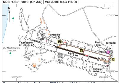
Surface Rwy Dim(m) TORA(m) LDA(m) Lighting 11/29 † Thr Rwy APAPI 3° 1412x46 Concrete/ 11-1412 11-1412 † Thr Rwy APAPI 3.5° Asphalt 29-1412 29-1412
